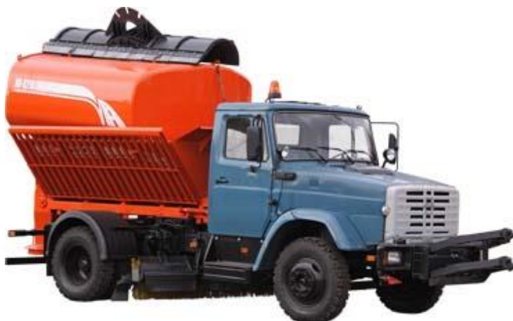
Рисунок 24. Машина КО-829АД на шасси ЗИЛ-43932
