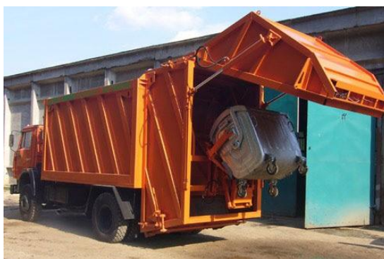
Рисунок 13. Машина для мойки контейнеров марки ТГ-100 на шасси КамАЗ
